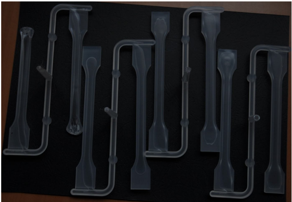
Rys. 13..1. Efekt zmiennego wypełnienia wnętrza wypraski gazem uzyskany przy zbyt wczesnym wtrysku gazu (wypraska od lewej strony zdjęcia, gdzie gaz przebił czoło stopu) i stopniowo opóźniany ten moment aż do uzyskania najlżejszej kształtki (wypraska z prawej strony zdjęcia)
