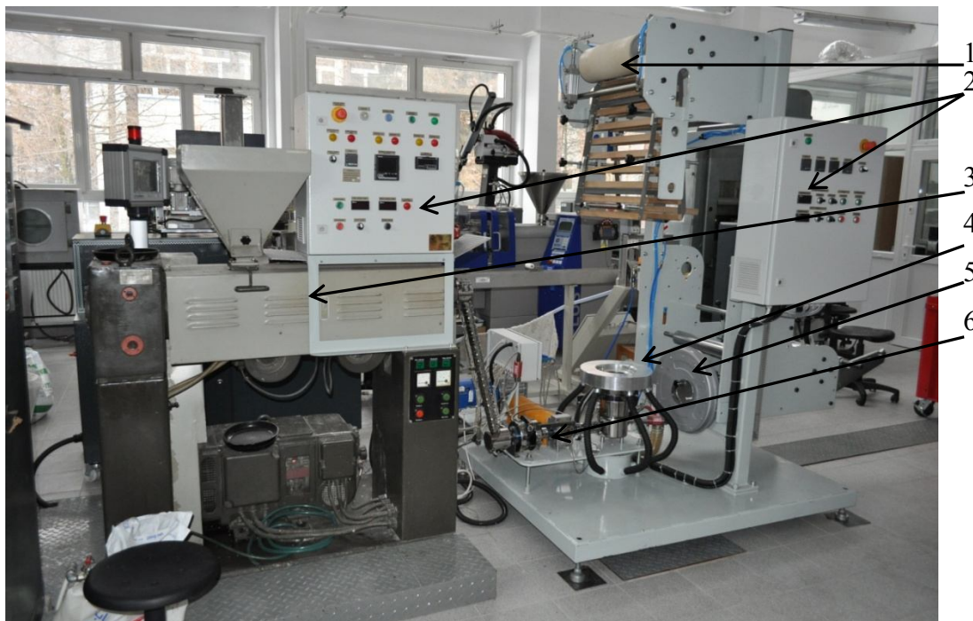
Rys. 11.1. Wygląd instalacji do wytwarzania folii z poliolefin metodą wytłaczania z rozdmuchem: 1- walce ciągnąco-odbierające wraz drabinką kierującą, 2- panele sterujące, 3- wytłaczarka T32 przystosowana do współpracy z linią rozdmuchu, 4- głowica krzyżowa, 5- wentylator powietrza schładzającego rękaw folii, 6- cylinder doprowadzający stop do głowicy z filtrem i pompą stopu
