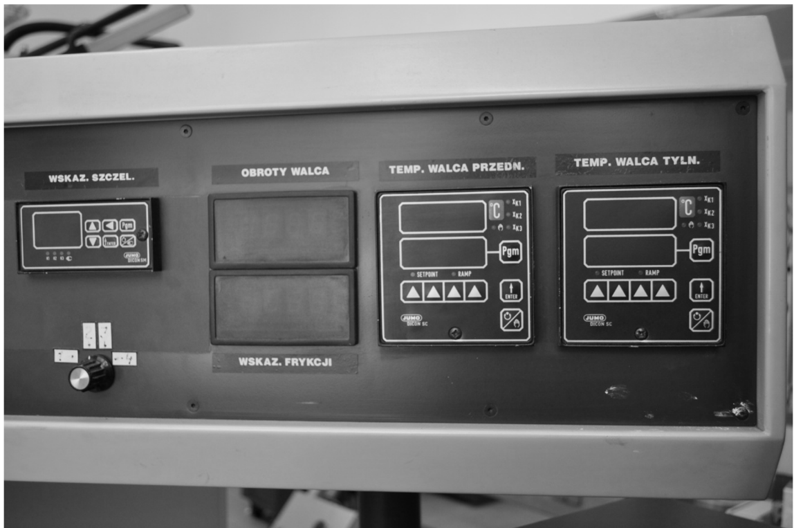
Rys. 7.1. Widok pulpitu walcarki
